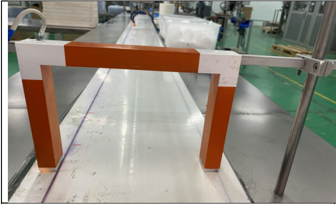
Рис.4. Щілева оптопара змонтована на конвеєрі
