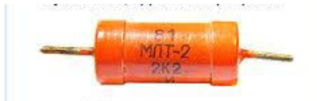
Рисунок 8.2 – Приклад маркування резистора у вигляді надпису на корпусі
