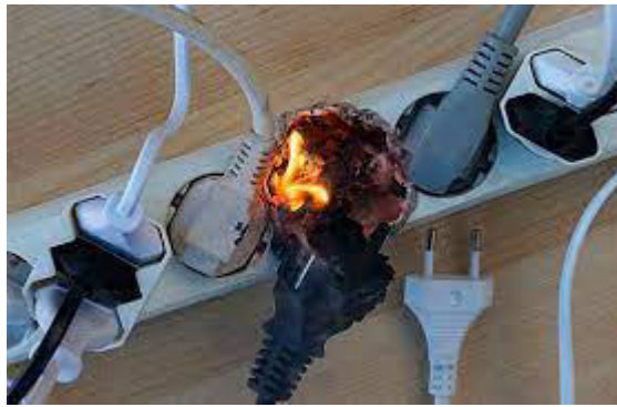
Рисунок 7.4 – Ілюстрація впливу на джерело живлення та з'єднувальні провідники режиму короткого замикання
