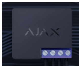
Рис. 3.1. Relay Jeweller реле компанії Ajax Systems [21]
