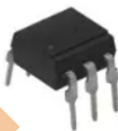
Рис. 4.6. Оптопара з симісторним виходом MOC3082 [26]
