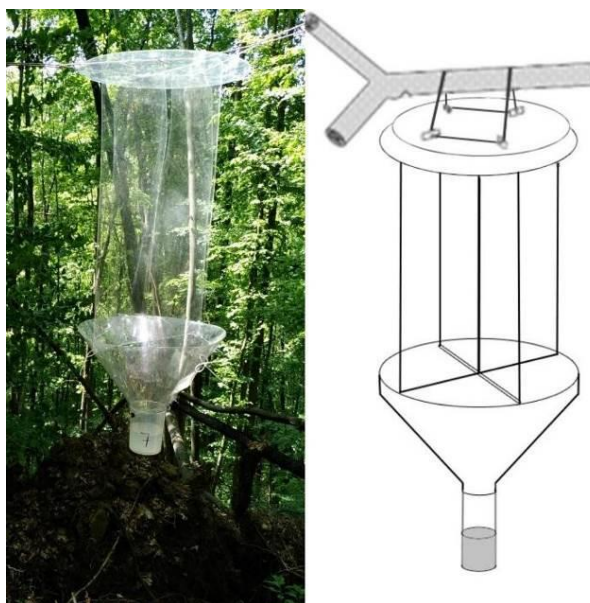
Рис. 3.2 Схема та загальний вид пастки.
