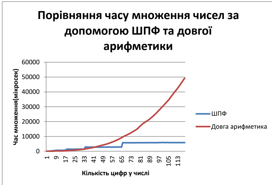
Рис. 1. Криві залежності часу виконання від довжини чисел для методів ШПФ та довгої арифметики
