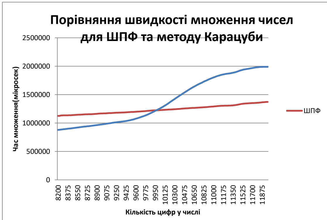
Рис. 2. Криві залежності часу виконання від довжини чисел для методу ШПФ та методу Карацуби
