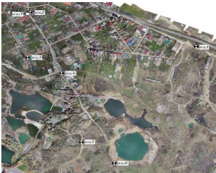
Рис.3.6.10. Схема закладання нівелірних ходів с.Солотвино [50]
