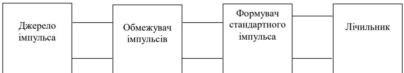
Рис. 1.2.1. Блок схема інтегрального дискримінатора
