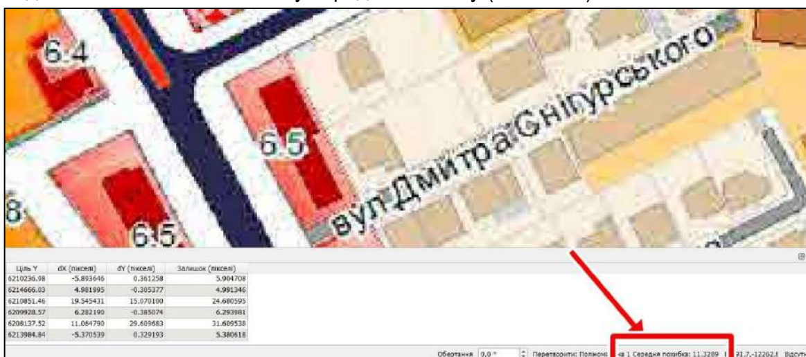
Рис. 1.20. Перевірка та контроль середньої похибки прив'язки
