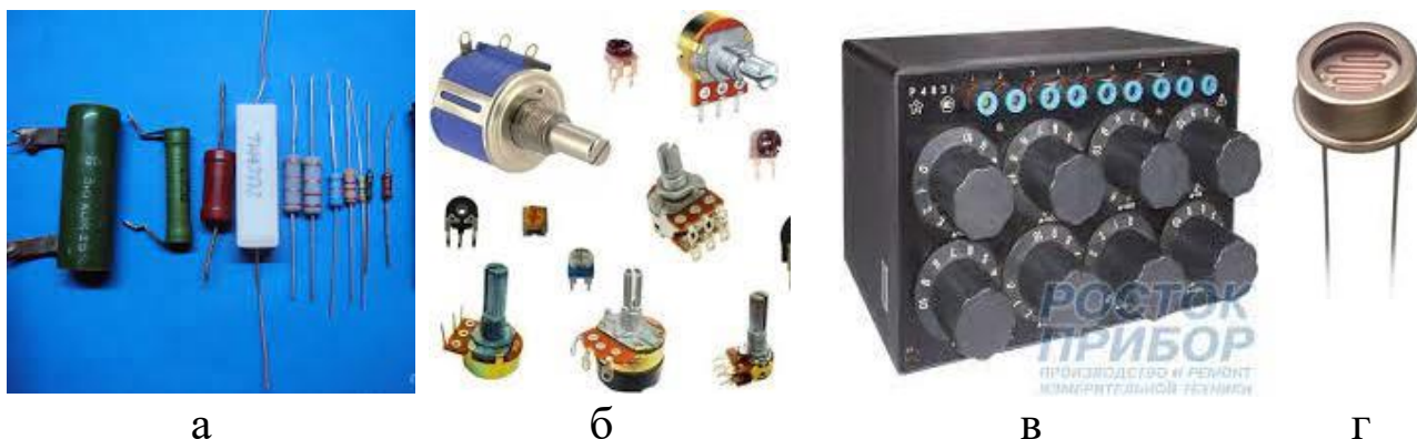
Рисунок 8.1. Зовнішній вигляд деяких типів резисторів: постійного опору (а), змінного опору (б), магазину опорів (в), фоторезистор (г)
