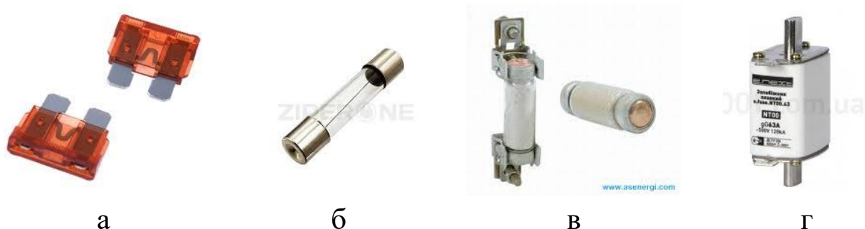
Рисунок 7.5. Типи плавких запобіжників: а – автомобільний, б – для електронної апаратури, в – для малопотужних енергетичних мереж, г – для високопотужних енергетичних мереж
