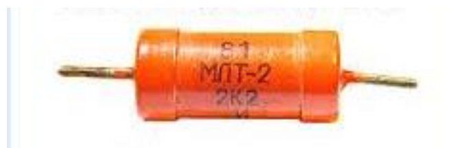
Рисунок 8.2. Приклад маркування резистора у вигляді надпису на корпусі
