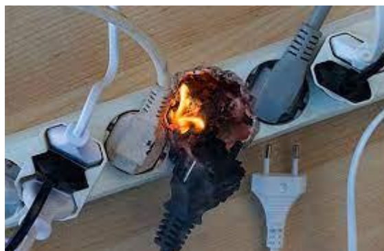
Рисунок 7.4. Ілюстрація впливу на джерело живлення та з'єднувальні провідники режиму короткого замикання
