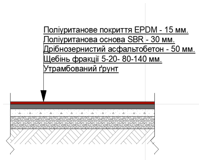
Рис. 2.2 Конструкція покриття бігової доріжки
