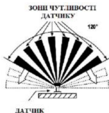
Рис. 9. Зони чутливості ІЧ-датчика
