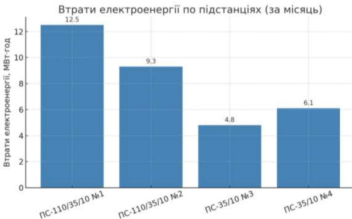
Рисунок 1.2 – Втрати електроенергії на підстанціях ПАТ «Хмельницькобленерго» (за місяць) [17]
