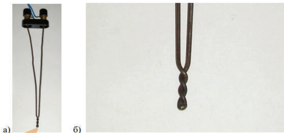
Рисунок 1.8 — а) варіант конструктивного виконання термопари б) типовий вигляд робочого спаю.
