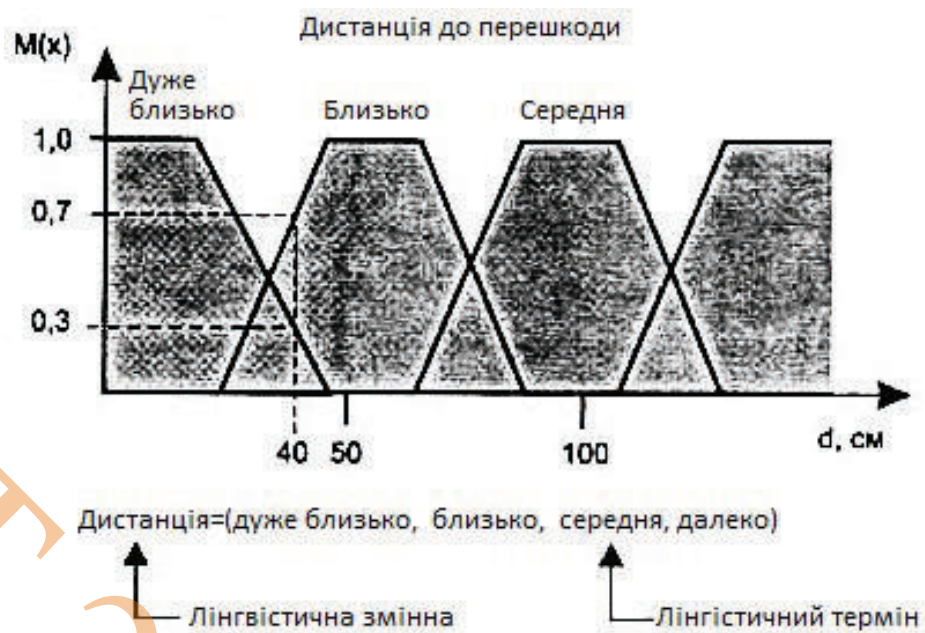
Рисунок 2.2 – Лінгвістичні змінні, лінгвістичні терми та функція приналежності відстаней до перешкод x для алгоритму програми руху міні робота
