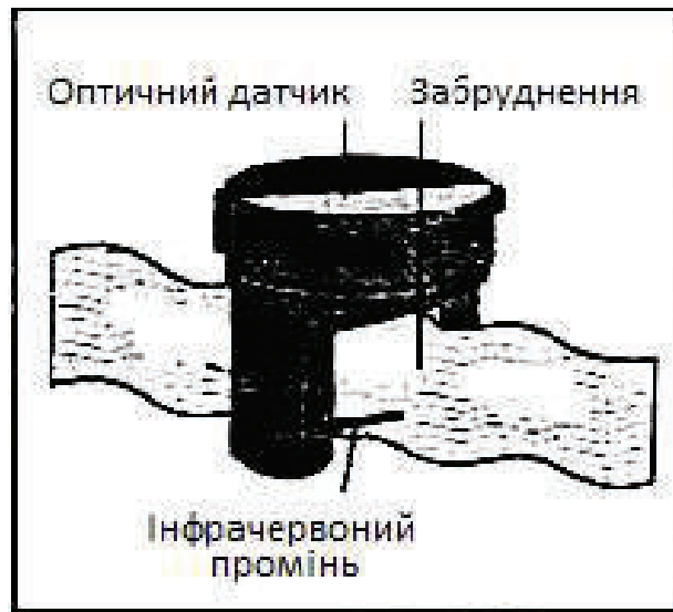
Рис. 3.2 – Принцип роботи давача рівня забруднення одягу
