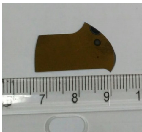
Рис 3.1.1 Фотографія кристалу GaAs:Zn, який використовувався при оптичних дослідженнях
