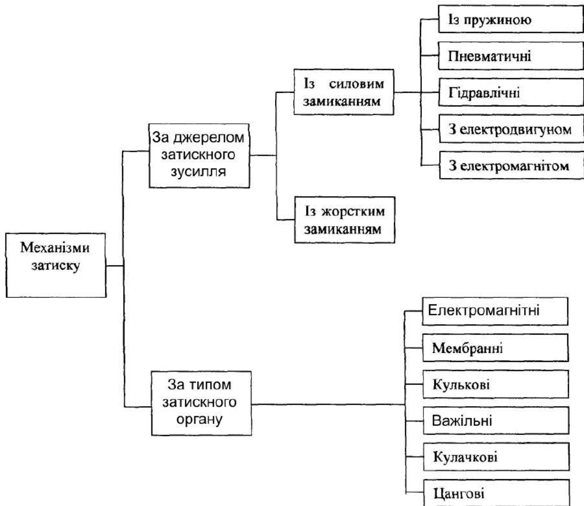
Рисунок 7.2. Класифікація механізмів затиску
