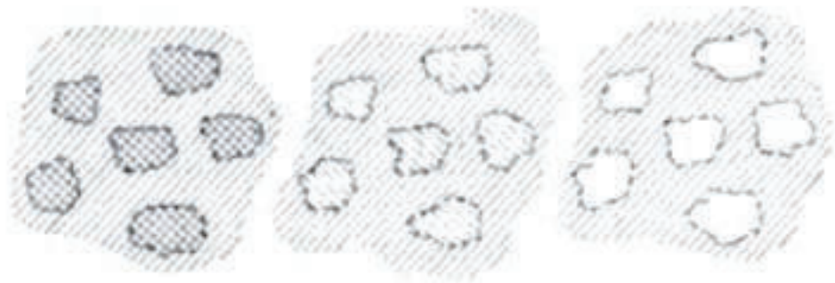
Рисунок 2.1 – Схематичне зображення структури пористого скла
