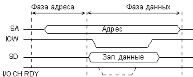
Рис. 2.3. Цикл запису в ПВВ на магiстралi ISA.
