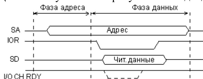
Рис. 2.2. Цикл читання з ПВВ на магістралі ISA.
