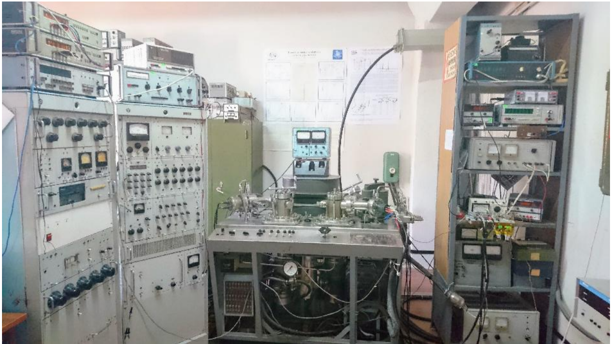
Рис. 3.2. Загальний вигляд експериментальної установки з магнітним мас-спектрометром МИ-1201 лабораторії мас-спектрометрії.
