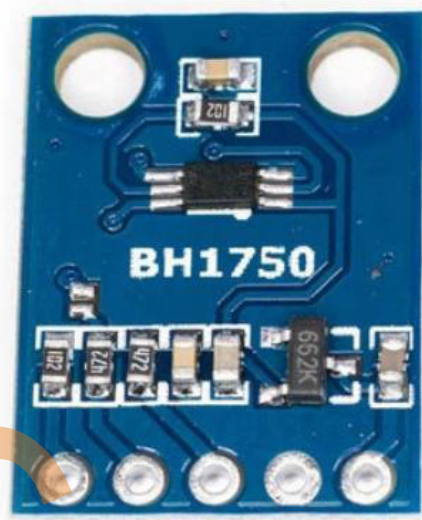
Рис.1.5 – Датчик освітлення BH1750
