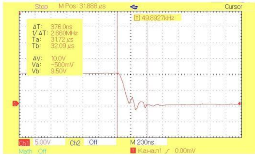
Рисунок 3.24 – Спад сигналу на затворі силового ключа при використанні IR2110 (вертикальна вісь - напруга, 5 В/под; горизонтальна - час, 200 нс/под)
