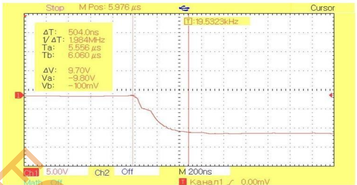
Рисунок 3.12 – Процес відмикання силового ключа (допоміжний транзистор – IRLZ24N), параметри дільника: R1 = 150 \text{ Ом} , R2 = 450 \text{ Ом} (масштаб: по вертикалі – 5 В/под, по горизонталі – 200 нс/под)
