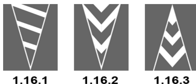
Рис. 2.13 Розмітка напрямного острівця
