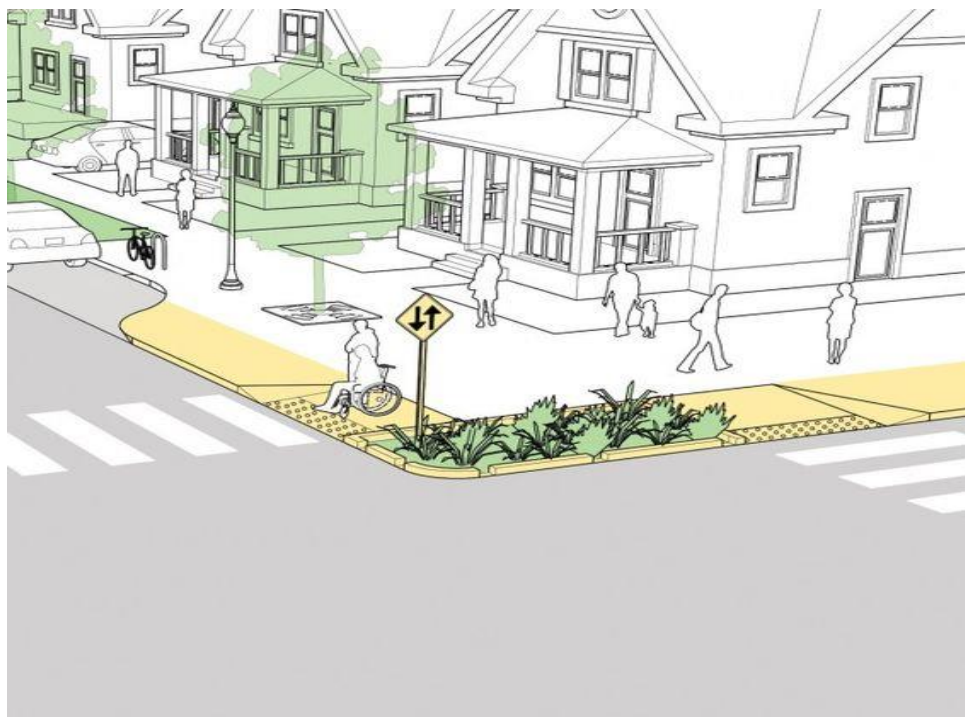
Рис. 2.26 Візуалізація влаштування притротуарного островця
